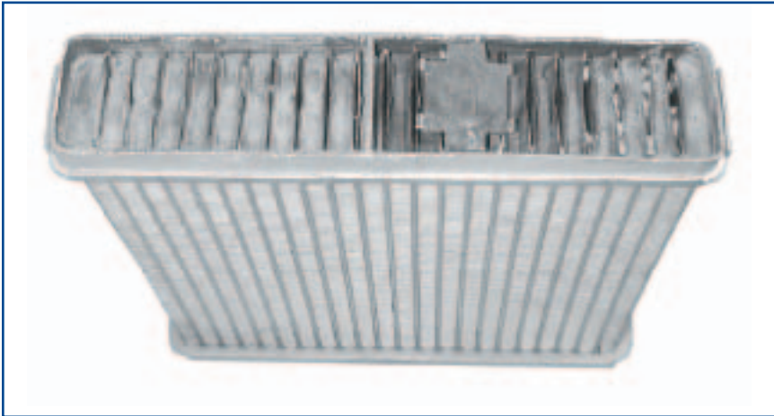
Exemple d'un radiateur de chauffage encrassé avec des débris de liquide de refroidissement.
