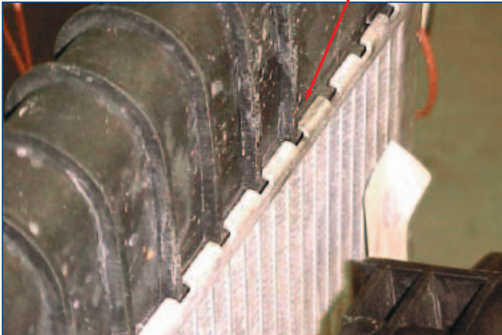
Fuite de joint suite à un mauvais agrafage d'un joint défaillant
