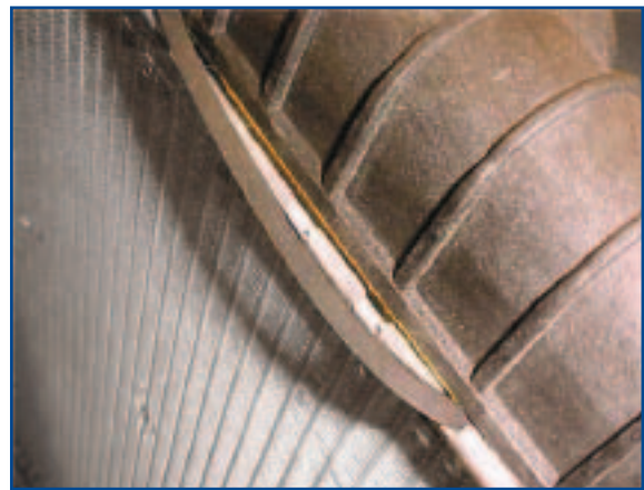
Joint éclaté du radiateur de plastique aluminium
