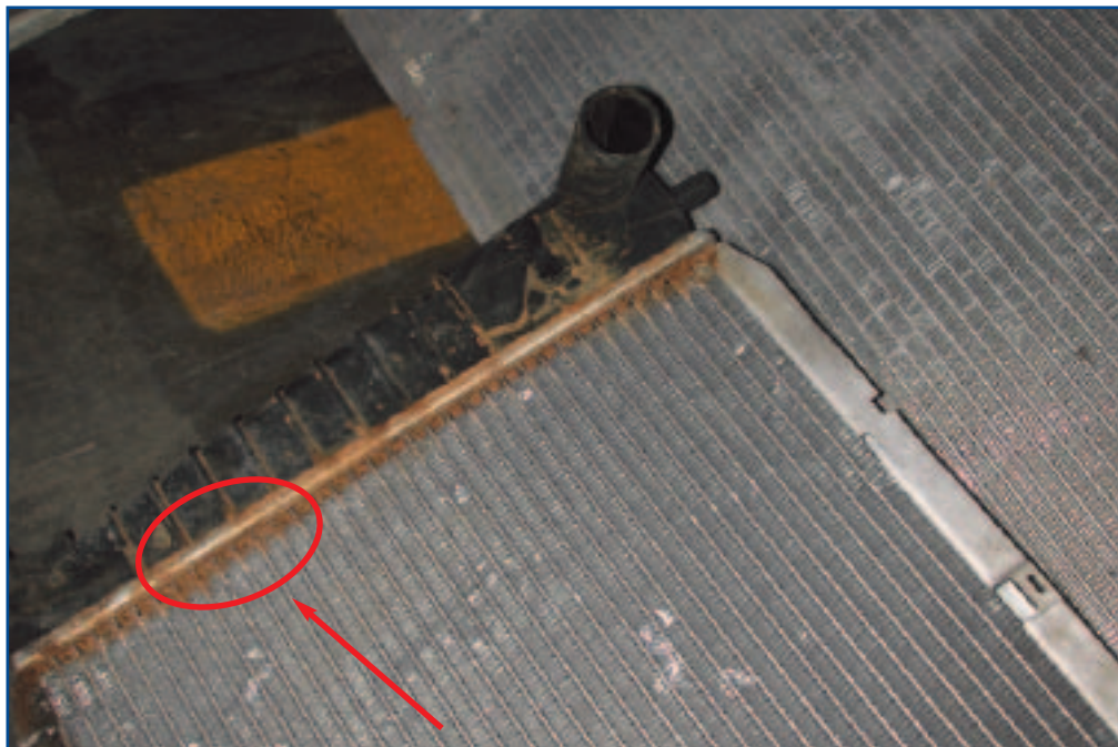
Joint du tube corrodé suite à une contamination d'antigel
